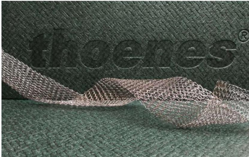
Die neuen Drahtgestricke von thoenes® können als Endlosware in unterschiedlichen Dimensionen hergestellt und vermarktet werden. Durch das Einstellen der Maschenanzahl längs ist es möglich, das Gestrück flexibel oder steifer zu gestalten, was unterschiedliche Dehnungen und Belastungen, je nach gewünschter Art der Anwendung zulässt. Auch die Stärke des einzusetzenden Drahtes spielt bei der Einstellung der zuvor genannten Eigenschaften eine entscheidende Rolle.
